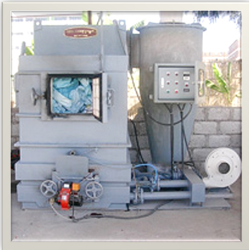
Печь для утилизации медицинских отходов, оборудована камерой внутреннего сгорания
