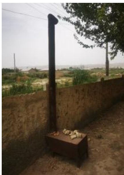
Фотография 14. Нефункциональная мусоросжигательная печь в РЦЗ Н. Хусрав
