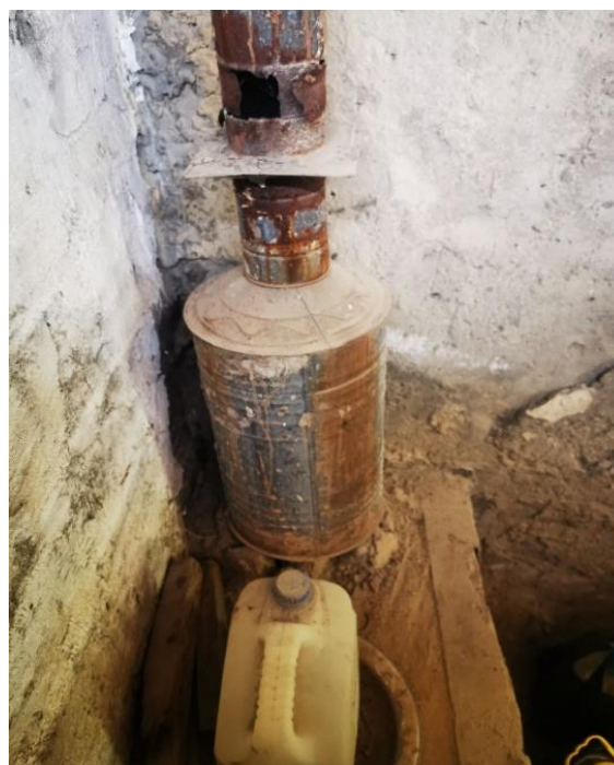
Фотография 31. Печь для сжигания МО в ГЦЗ г. Пенджикент
