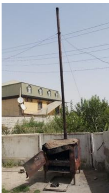
Фотография 5. Мусоросжигательная печь в РЦЗ Левакант
