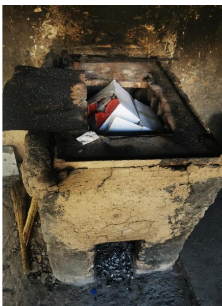
Фотография 28. Печь для сжигания МО в РЦЗ Айнинского района
